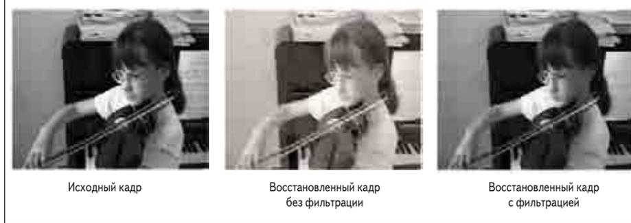
Рис. 17. Пример применения деблокирующего фильтра
