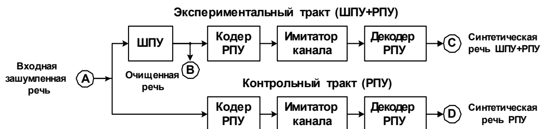
Рис. 2. Схема испытаний ШПУ совместно с РПУ.
