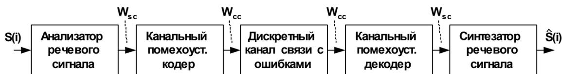
Рис.1. Блок-схема цифровой системы речевой связи.
